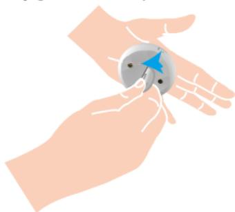
3. Mantenga pulsado el botón del sensor de agua durante 5 segundos y, a continuación, el sensor de agua entrará en el modo de añadido de dispositivos.
